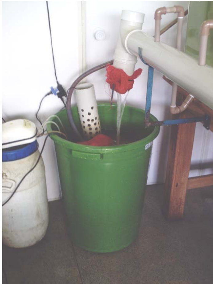
Fig. 15. filtro biológico utilizado no ensaio de desempenho de tilápias-do-nilo alimentadas com diferentes níveis de farelo de coco.
