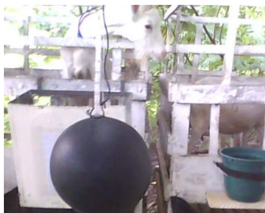
Figura 6: Termômetro de globo negro, detalhe do sensor externo do termo-higrômetro digital
